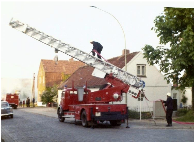
Aufbau einer Schlauchbrücke mit der DL 30
