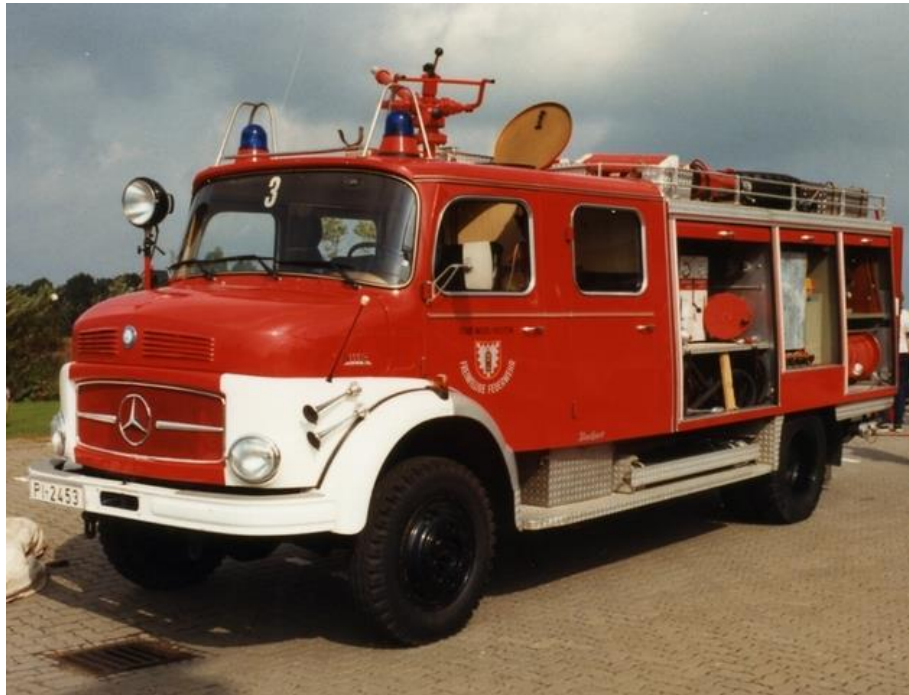
Trockentanklöschfahrzeug 16 ( TroTLF 16) Daimler Benz DB LAF1113 Lieferant: Gebr. Bachert, Bad Friedrichshall Preis 148.669,60 DM 1991 übergeben an die Feuerwehr Wolgast
