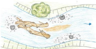
Skizzen zum Totholz- und Kieseinbau, BWS GmbH 2014
